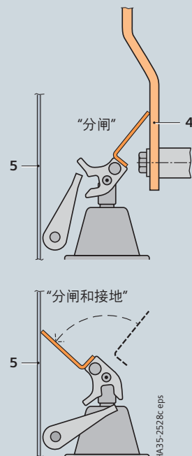
馈线电压互感器的隔离装置 (详图 Z)
